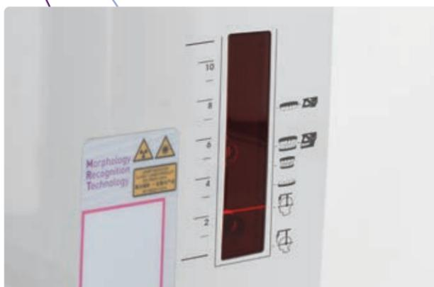
L'iconografia fornisce un utile riferimento visivo per il corretto posizionamento del laser orizzontale a seconda della tipologia di esame, così da garantire la massima accuratezza diagnostica per immagini 2D, 3D e CEPH.
